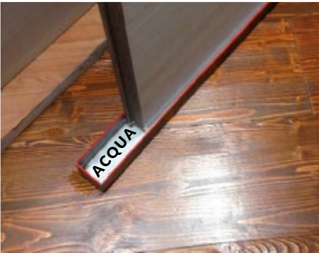
Test con anta immersa in acqua
